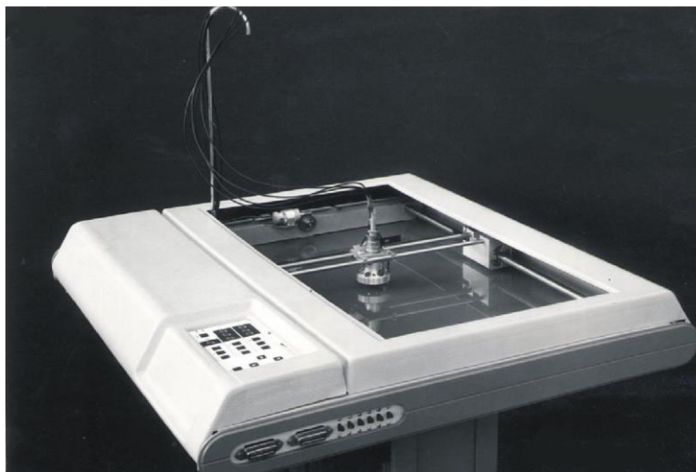
Рис.1.6. Опытный образец сканирующего устройства со встроенным вычислительным блоком, предназначенный для количественной оценки визуальной массы черно-белых изображений и её производных (разработка ГНИПИ 1983г.)
